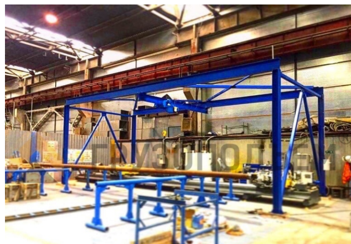
Кран мостовой опорный с электроприводом грузоподъемностью 2,0 тонны и длиной пролета 4,15 метров в комплекте с легкой подкрановой эстакадой длиной 12,0 метров для предприятия в Санкт-Петербурге.
