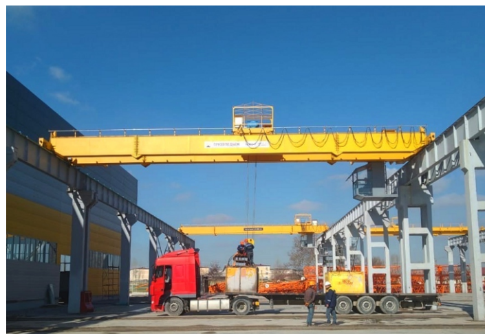
Краны мостовые опорные двухбалочные с электроприводом грузоподъемностью 10,0 и 16,0 тонн, длиной пролета 22,5 метров для предприятия в Республике Узбекистан.
